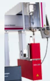
Die Dynamische Headspace-Technik mit dem GERSTEL-MPS erweist sich als leistungsstarkes Werkzeug bei der Analyse von Lebensmitteln, Kunststoffen oder Produkten für die Körperpflege. Da Temperatur, Adsorbens und Art der Probe obendrein frei wählbar sind, empfiehlt sich das DHS-System für eine Vielzahl von Anwendungen im Bereich der Thermoextraktion als Mittel der Wahl.
